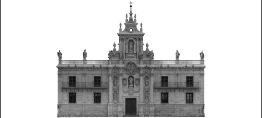
Levantamiento de la fachada de la Universidad de Valladolid. Lab. Fotogrametría ETSAVA
